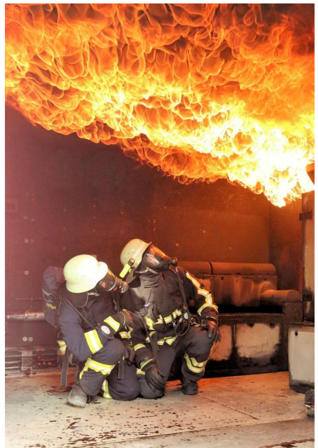
Simulation eines sog. Flashovers im Brandcontainer
